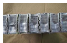
図-3 車両用ラジエータのフィン構造
